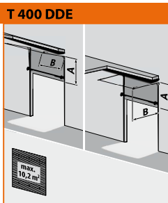
T 400 DDE Podniesiony system prowadzenia bez sprężyny
