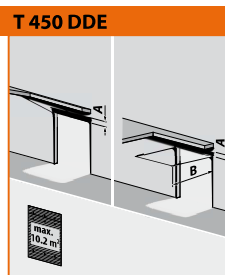
T 450 DDE Normalny system szyn podnoszących z wstępnie zmontowanymi sprężyna- mi i niskim położeniem wału
