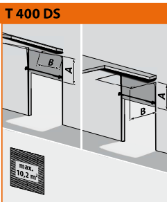
T 400 DS Podwyższony system prowadnic z obniżonym wałem
